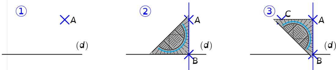
Par construction, les droites  $(d)$  et  $(AC)$  sont perpendiculaires.
