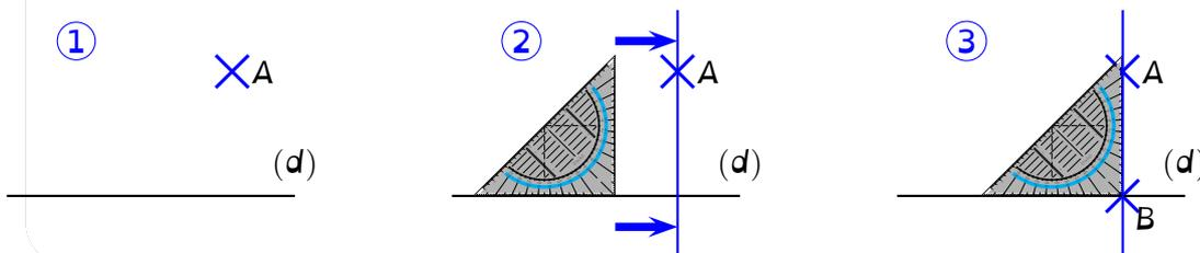
Par construction, les droites  $(d)$  et  $(AB)$  sont perpendiculaires.
